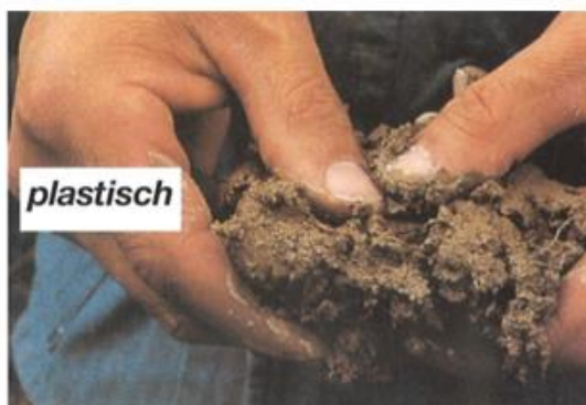
Abbildung 1: Anleitung zur Fühlprobe für die Beurteilung der Zulässigkeit bodenrelevanter Arbeiten.
