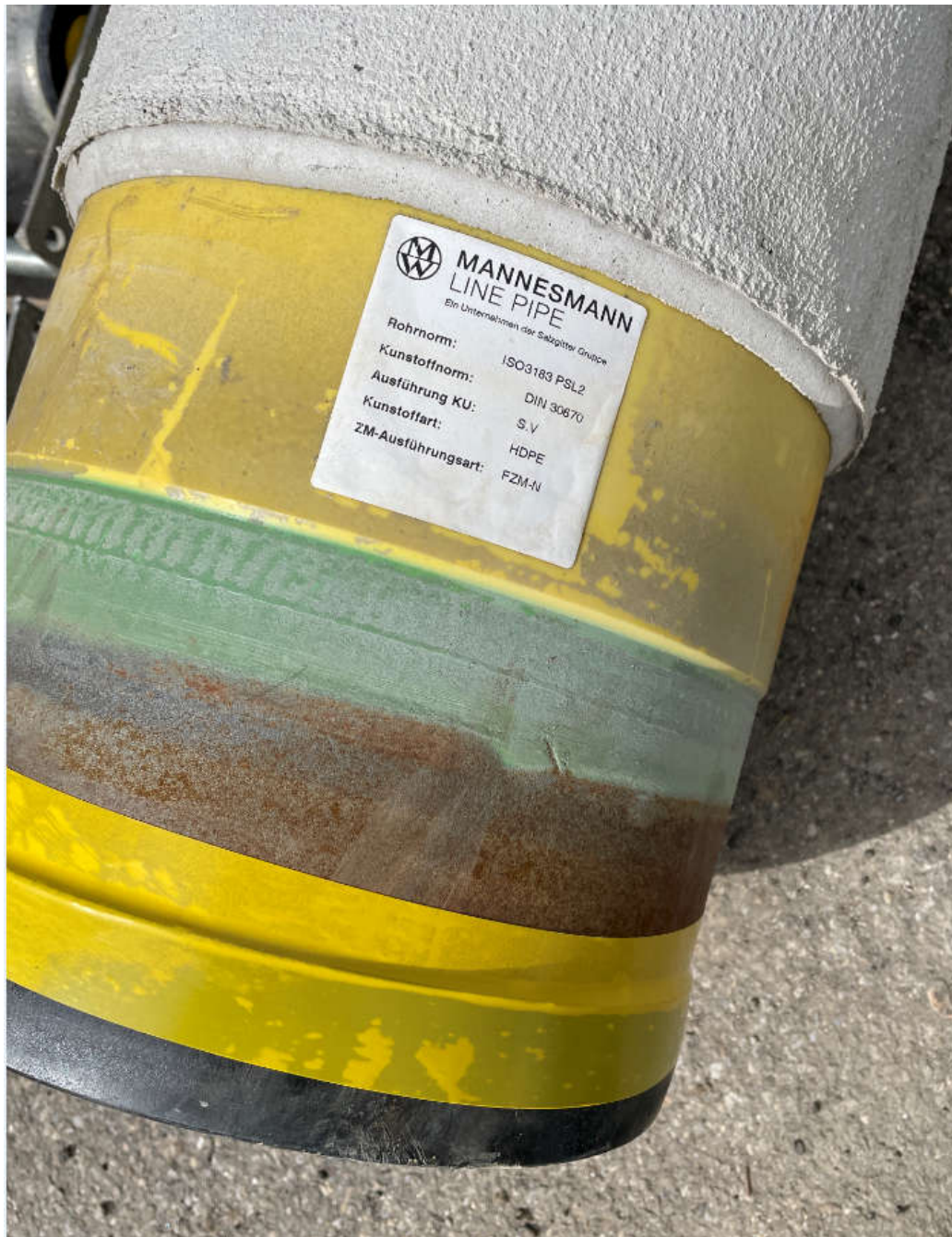
Abbildung 3 Rohrkonfektionierung, Stahlrohr, Isolierschicht aus Hochdruck-Polyethylen und Faserzementhülle (Quelle, Energie 360° AG)
