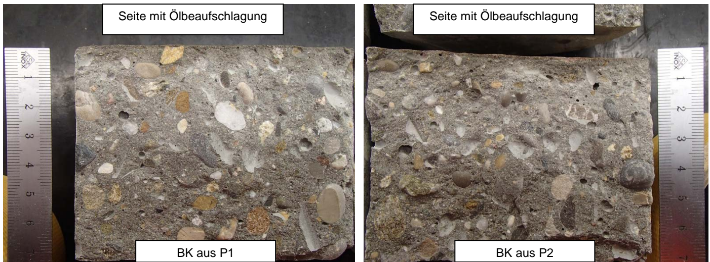
Fig. 7: Detailansicht Bohrkern aus P1 und P2
