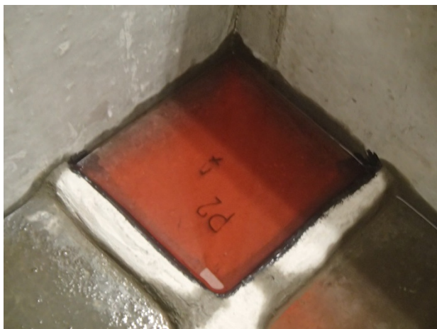
Fig. 5: Kapillare Wirkung des Öls nach 72h
