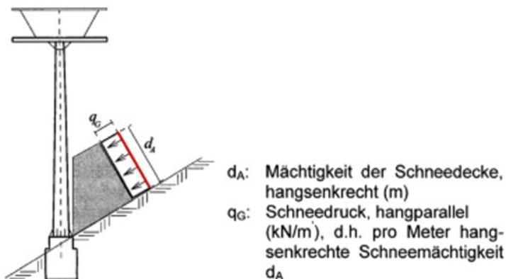
Abbildung 10: Schema Einwirkung Schneedruck [10].
