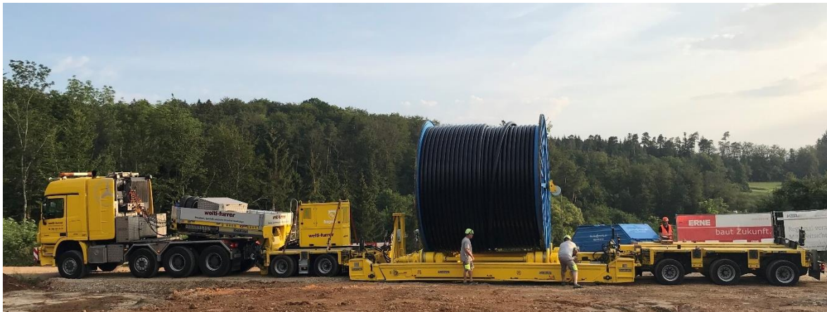
Abbildung 23: Beispiel möglicher Fahrzeugkombination zum Bobinentransport
