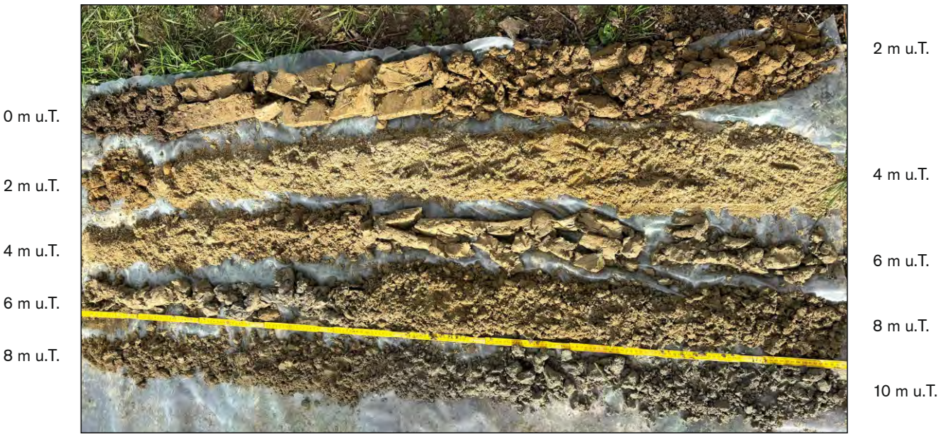
Rammgut Rammkernsondierung MS2-Süd-RKS1
